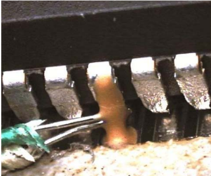
Рисунок 9: Прикрепление термопары без оболочки с помощью клея для монтируемых на поверхности плат радиоэлементов
